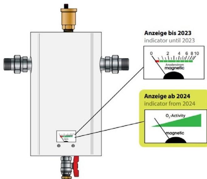
*Das Heizungswasser-Reguliergerät Typ Magnetic HWR 10 Plus verfügt bereits über eine vollwertige Anodenanzeige.*
