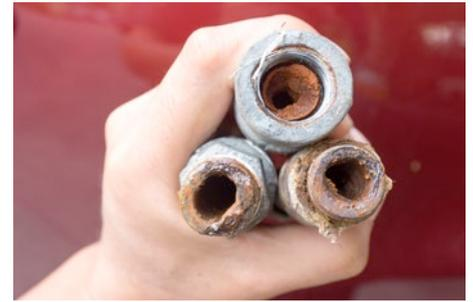
*Verkalkte und verschlammte Kugelhähne und Rohre nach wenigen Jahren bei Betrieb der Heizungsanlage mit nicht aufbereitetem Wasser*
